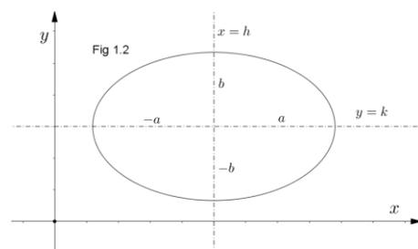
L'équation  $\frac{(x-h)^2}{a^2} + \frac{(y-k)^2}{b^2} = 1$  représente la même ellipse par rapport aux axes  $x = h$  et  $y = k$ , ce qui implique que le centre de la conique a pour coordonnées  $C(h, k)$  (fig. 1-2).
