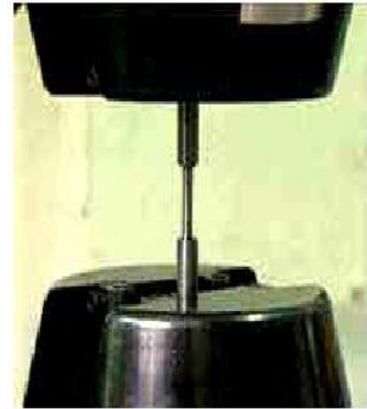
3 – Détail des mors et de l'éprouvette
