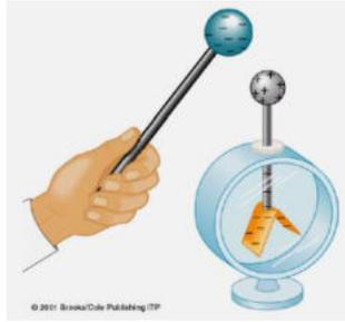
**Figure 13.25 :** Electrification par influence. La tige négative repousse les électrons vers les feuilles de l'électroscope. Les deux feuilles portant le même signe se repoussent et s'écartent.
