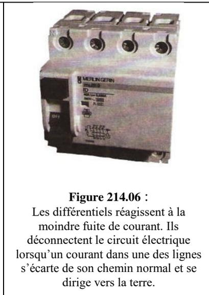
**Figure 214.06 :** Les différentiels réagissent à la moindre fuite de courant. Ils déconnectent le circuit électrique lorsqu'un courant dans une des lignes s'écarte de son chemin normal et se dirige vers la terre.
