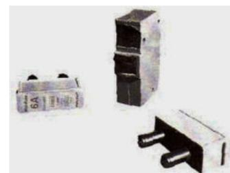
**Figure 214.04** : Dans les vieilles installations domestiques on trouve encore des fusibles à la place des disjoncteurs. Ceux-ci sont constitués d'un fil de section beaucoup plus petite que dans les circuits dans lesquels ils ont placés. Si une surintensité apparaît dans un circuit, c'est le fil du fusible, qui en premier lieu va surchauffer et se rompre empêchant alors le courant de continuer à circuler.
