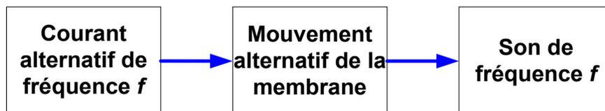
*Le HP transforme un courant alternatif en un son de même fréquence*
