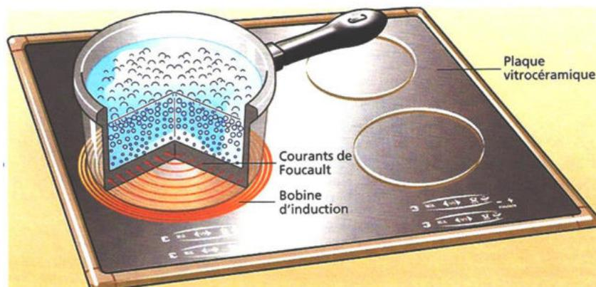
Figure 36-24 : Principe de fonctionnement d'une plaque à induction. Une bobine située sous la plaque engendre un champ magnétique variable. Des courants de Foucault s'établissent alors dans le fond de la casserole, qui s'échauffe par effet Joule.
