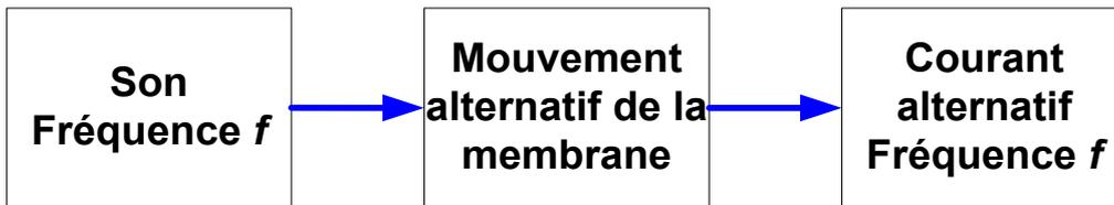
*Le microphone transforme un son en un courant alternatif de même fréquence.*
