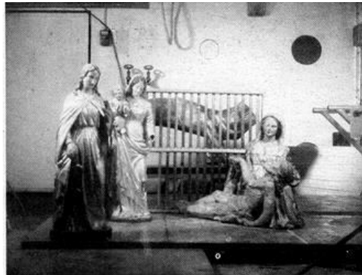
7. Conservation d'objets d'art. Consolidés par polymérisation sous irradiation, ces objets deviennent imputrescibles.
