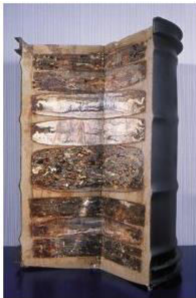
Coupe d'un fût de 400 l. On distingue les différentes galettes et la matrice d'immobilisation.
