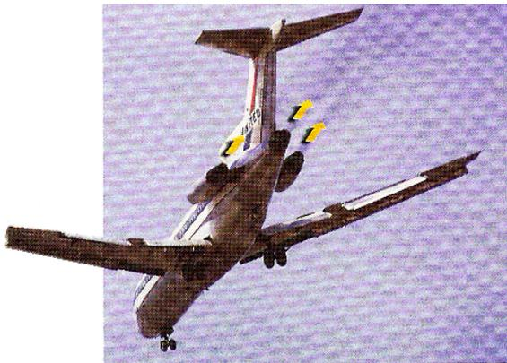
Un avion à réaction aspire l'air atmosphérique et l'aspulse à grande vitesse : ce qui pousse l'avion. Les moteurs poussent le gaz vers l'arrière et le gaz pousse les moteurs vers l'avant. La quantité de mouvement totale du gaz vers l'arrière est égale, en module, à la quantité de mouvement de l'avion vers l'avant.
