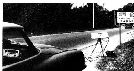
**Le cinémomètre.** Cet appareil comporte un émetteur fixe qui envoie une onde connue vers la voiture. L'onde réfléchiée sur celle-ci est analysée par un récepteur et permet de connaître la vitesse du véhicule avec une bonne précision.
